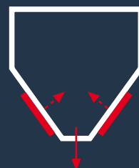
Система Walk-Ex® служит для обрушения сводов сыпучего материала.
