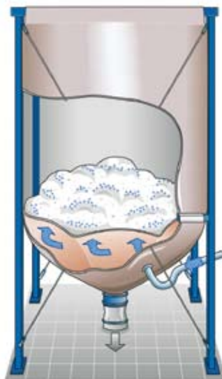
Текучесть сыпучего материала восстанавливается за счет целенаправленного нагнетания воздуха (Система Fluid-Ex® в разрезе)
