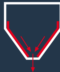
Fliess-Ex® обеспечивает в нижней части силоса максимально возможную „гладкость“ стен выпускной воронки.
