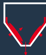
Воздушные рукава большого диаметра в системе Pneum-Ex® изменяют постоянно форму и угол наклона воронки в конической части силоса.
